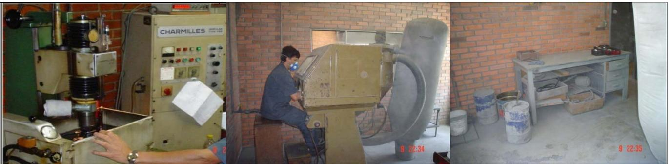
Fig. 19(a): Processo de eletroerosão por penetração, (b) processo de jateamento em peças de METAL-DURO (c). Acúmulo de poeiras de SiC no chão.
