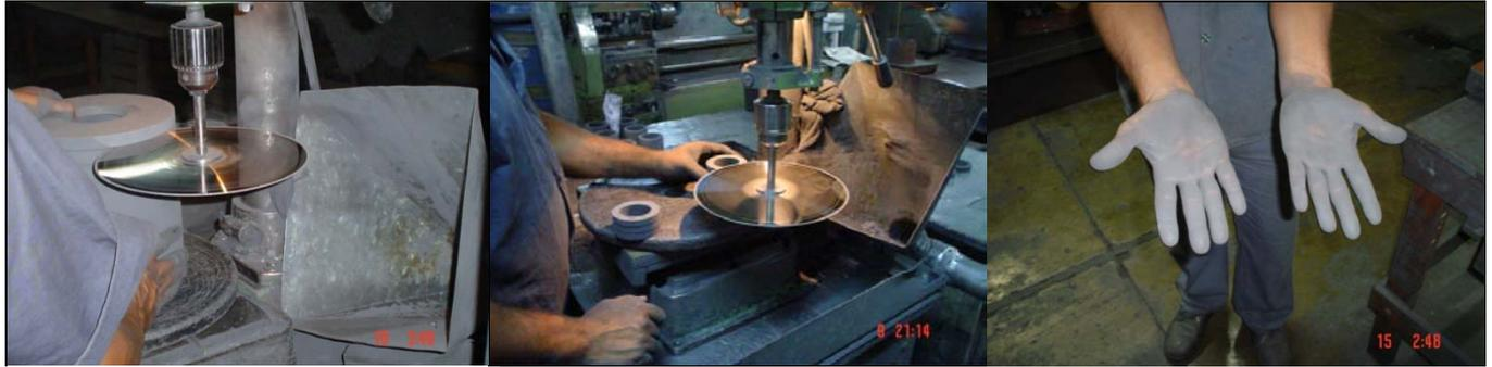
Fig. 15(a): Pré-usinagem de tarugos de misturas compactadas, (b) corte de *blanks* cilíndricos de metal-duro compactado e (c) profissional apresentando as mãos impregnadas de pós-metálicos de metal-duro.
