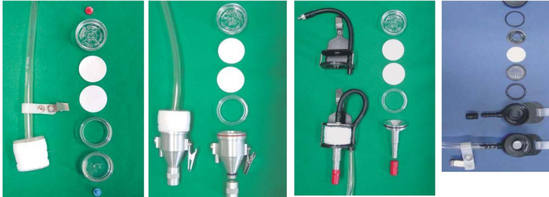
Fig. 7 (a): Dispositivo de coleta para particulado total (cassete); (b). Dispositivo de coleta para particulados torácico e respirável; (c) Dispositivo de coleta para particulado respirável (alumínio) e (d) Dispositivo de coleta tipo IOM particulado inalável (FUNDACENTRO, 2009).
