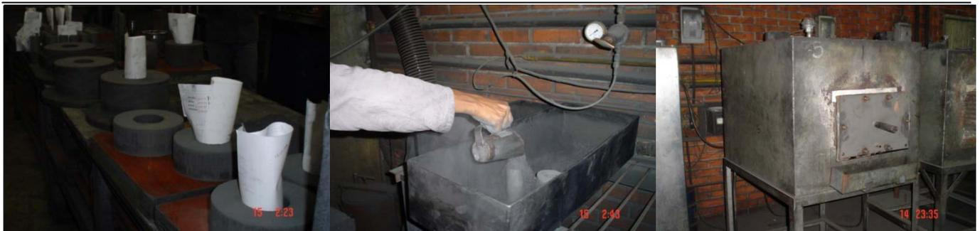
Fig. 13(a): Peças compactadas a verde; (b) Preparação e colocação do compactado em caçambas de aço para sua entrada no forno com atmosfera de hidrogênio; e (c). Fornos de pré-sinterização.
