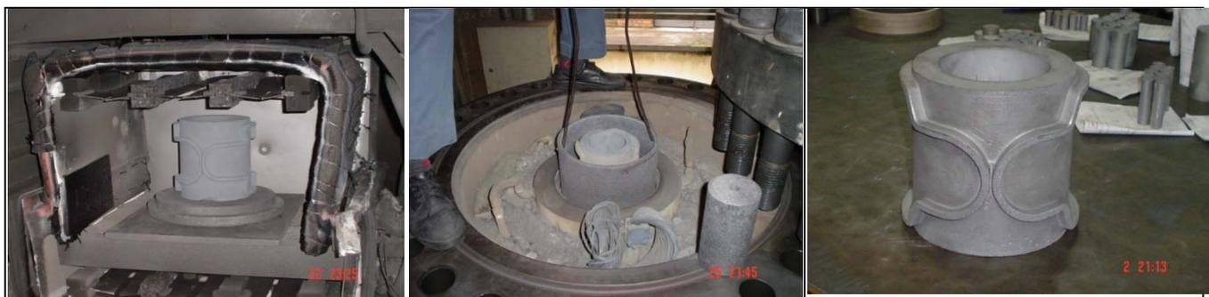
Fig. 17(a): Parte interno de um forno de Sinterização a vácuo; (b) produto sendo colocado no forno sínter HIP; e (c) produto sinterizado no forno sínter HIP.
