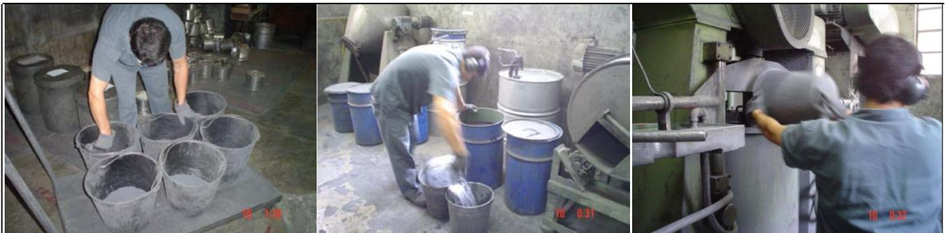
Fig. 9(a): Pesagem dos pós-metálicos; (b). Mistura dos pós-metálicos com solventes; e (c). Enchimento da mistura híbrida no moinho de bolas de alta energia.
