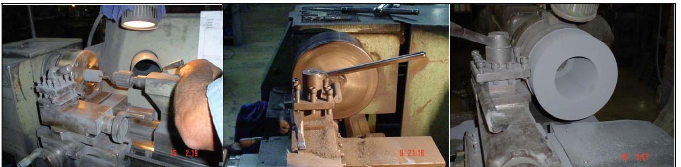
Fig. 14(a): Torneamento de uma bucha; (b) Placa de torno de movimento para execução do torneamento de um cilindro. e (c). tarugo de grande dimensão para torneamento.
