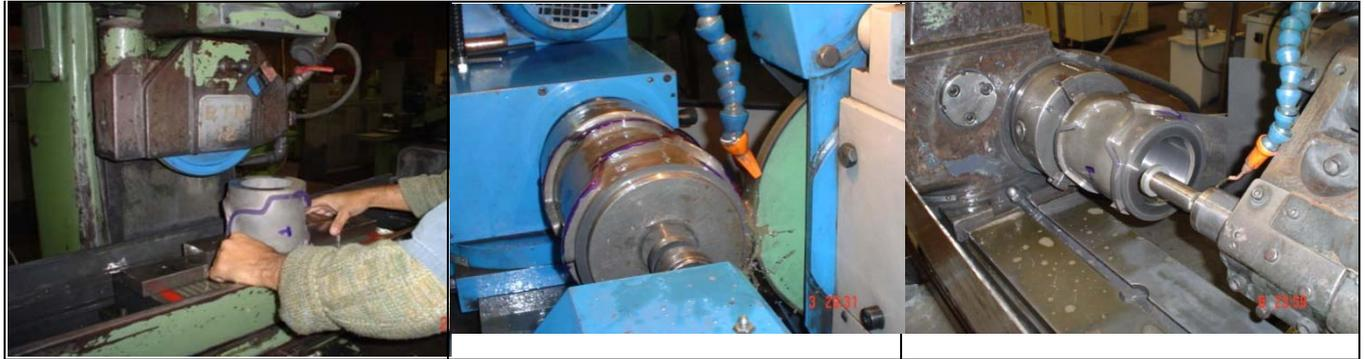
Fig. 18 (a): Retifica Plana.; (b) Retifica Cilíndrica. e (c). Retifica Cilíndrica Universal.
