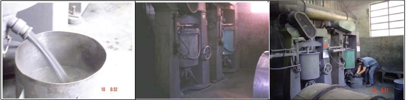
Fig. 10(a): Descarga da mistura moída com solvente aromático; (b) Moinho Attritor de alta energia; e (c). fechamento da válvula do moinho Attritor e decantação para separação do sólido e líquido.
