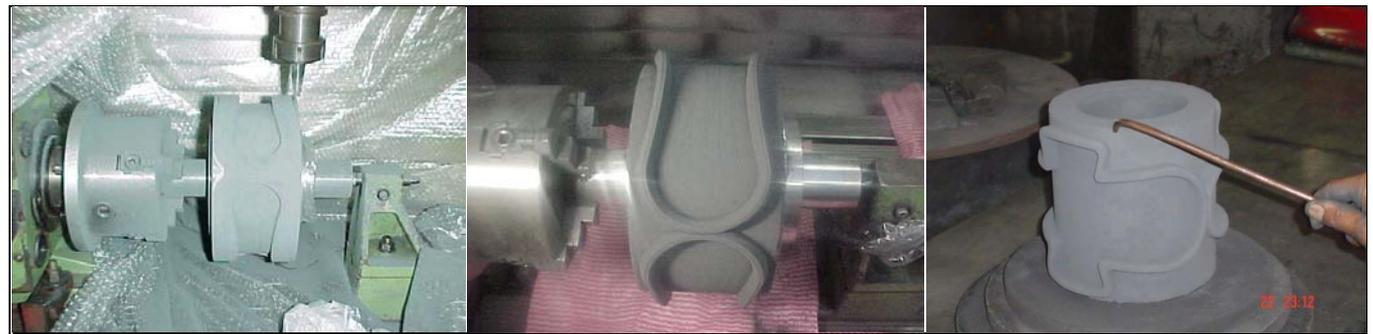
Fig. 16(a): Fresamento CNC em 3 eixos; (b) peça a verde acabada; e (c). limpeza da peça a verde para remoção de pós impregnados nos cantos ou rebaixo da peça, com nitrogênio gasoso em baixa pressão.
