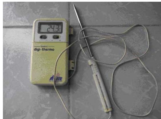
Fig. 4 : Digital Thermometer
